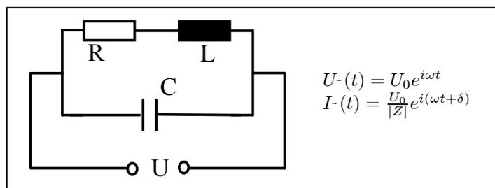
Zur oberen Strombahn gehört nach der Regel *Reihenschaltung* die Impedanz  $Z_1 = R + i\omega L$ , zur unteren gehört  $Z_2 = \frac{1}{i\omega C}$ . Die Parallelschaltungsregel gibt für die Gesamtimpedanz
