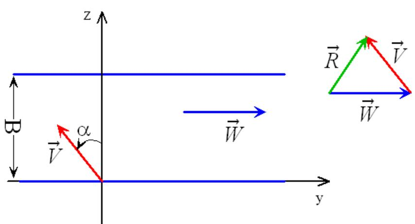
Dann folgt für die Bootsgeschwindigkeit  $\vec{V}$  relativ zum Wasser:  $\vec{V}^K = (0, V \sin \alpha, V \cos \alpha)$  wie vielfach geübt. Und  $\vec{W}^K = (0, W, 0)$ . Damit
