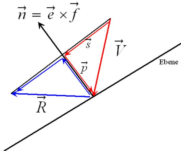
Es sei  $\vec{V} = \vec{s} + \vec{p}$ , wobei  $\vec{p}$  die zu  $\vec{n}$  parallele Komponente von  $\vec{V}$  ist. Dann gilt  $\vec{R} = -\vec{p} + \vec{s} = \vec{V} - 2\vec{p}$ , wobei  $\vec{p} = \vec{n} \frac{(\vec{n} \cdot \vec{V})}{|\vec{n}|^2}$  ist.
